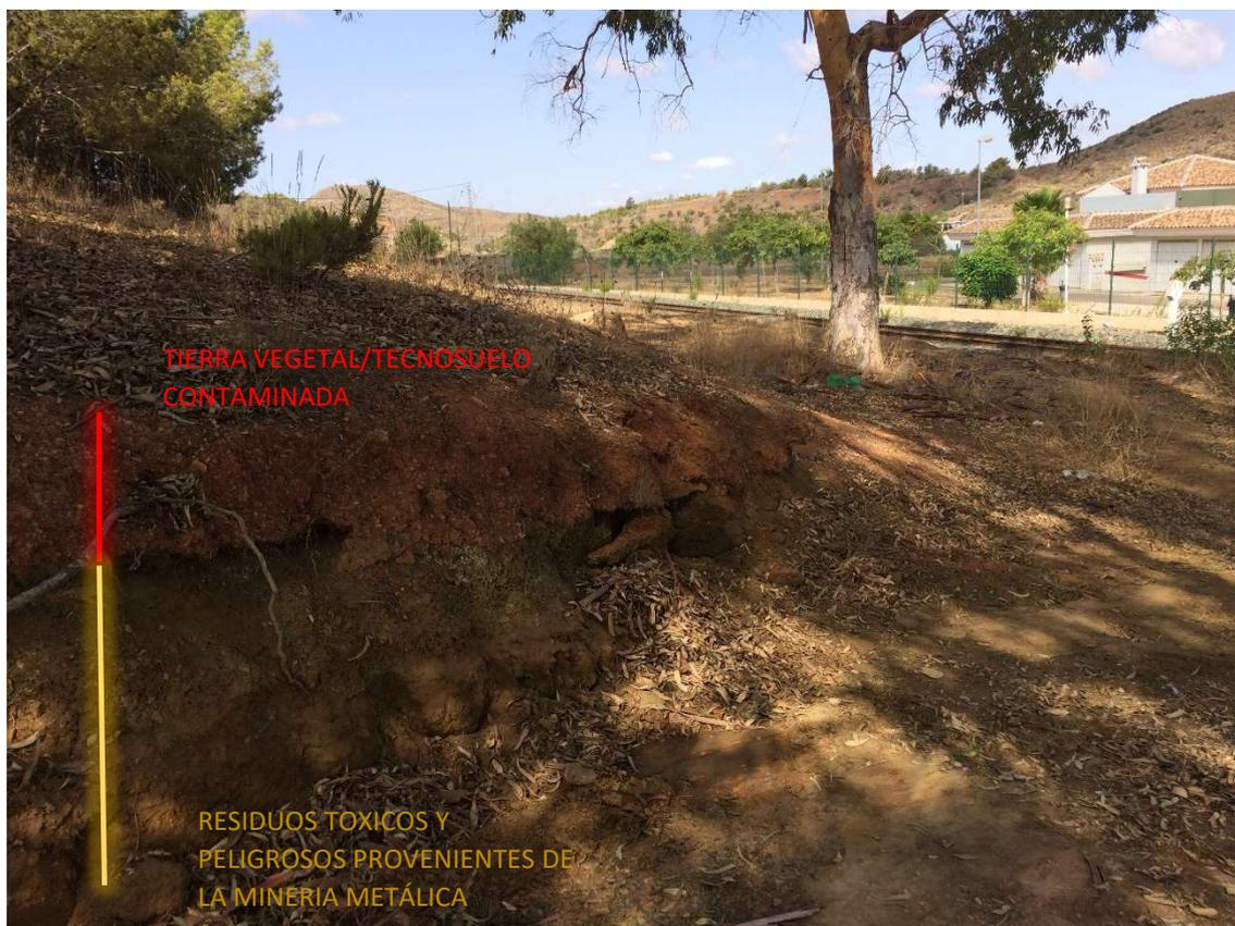
*Foto 7: Recubrimiento del depósito de residuos por tierra vegetal de color rojizo y textura grosera. Este sustrato se encuentra contaminado nuevamente habida o cuenta que es no la correcta tecnología que debiera aplicarse sobre la base de la clasificación de los residuos referida en el cuerpo de la presente denuncia. Bajo esta capa de tierra vegetal subyacen los residuos de la minería de color ocre, textura fina y pH ácido/extremadamente ácido.*
